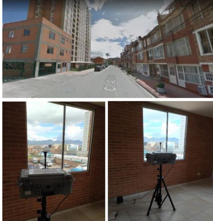
Fuente: equipo técnico línea Aire, Ruido, Rem, noviembre 2020. Conjunto Residencial Timiza del Parque, Kennedy. Monitoreo de material particulado.
